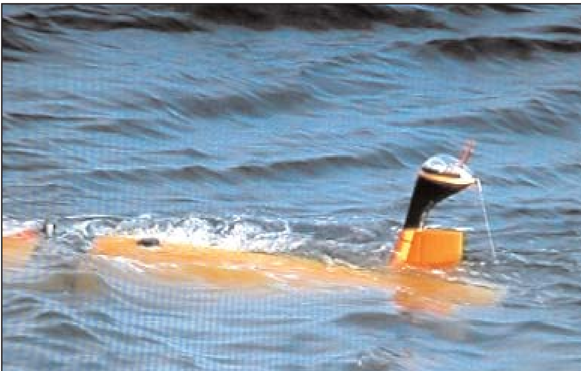
Imágenes de la liberación de un AUV desde una embarcación. El vehículo se autopilota. Arriba a la izquierda el resultado de un barrido con ecosondas localizando un ducto en el fondo marino.
